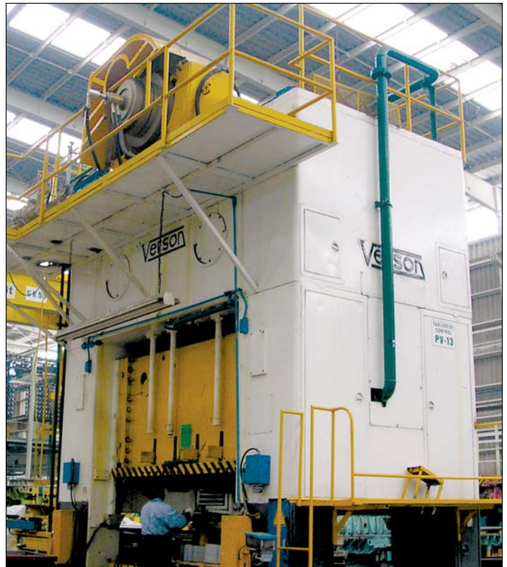
Press Pac® 2232 Separate Clutch & Brake Verson® 600 Ton Stamping Press Installation
